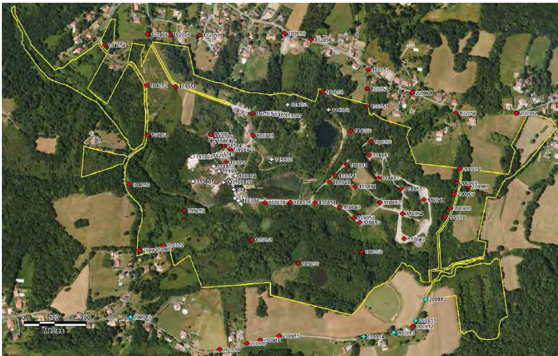
Les bornes repérées en rouge et en bleu seront relevées périodiquement
