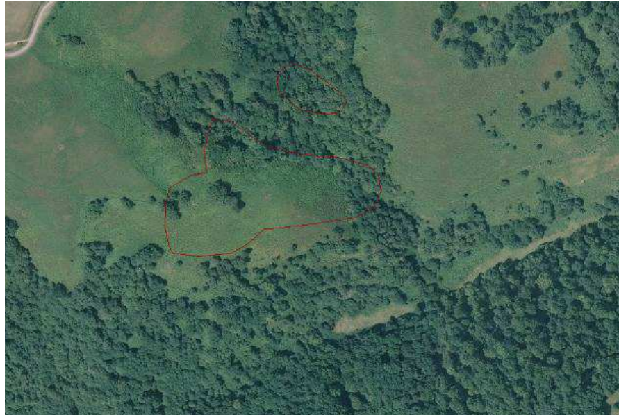
Figure 66 : Exemple d'enveloppes de glissements non validées pour la cartographie CIPRIP. Aucun critère de mouvements mécaniques, de traces d'arrachements amont n'est observable sur les photographies aériennes récentes ou anciennes. L'enveloppe située dans la forêt a également été invalidée.
