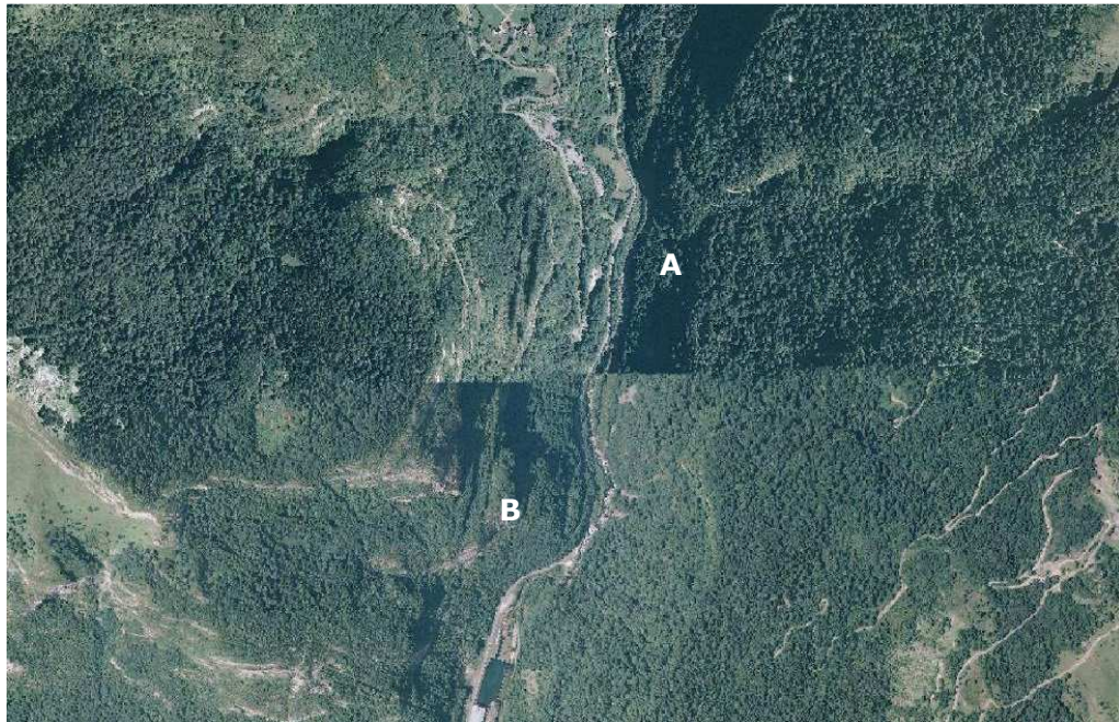
Figure 39 : Exemple de mosaïquage entre deux photographies prises sous des angles différents (Azimut d'illumination solaire vers l'ouest en A et azimut d'illumination solaire vers l'est en B. Secteur des Eaux Chaudes (Bassin d'Ossau).
