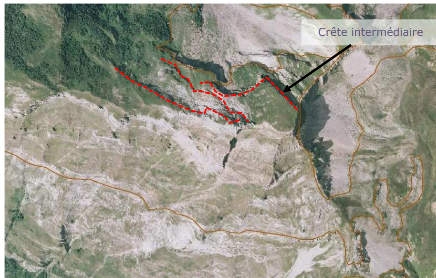
Figure 65 : Secteur du Pic de Cézy. Les pointillés rouges soulignent des ressauts ou crêtes intermédiaires créés par des lithologies compétentes au sein de l'unité des calcaires gréseux du Santonien. Ils créent en contrebas des zones de faible pente jouant le rôle de « piège » au sein desquels les blocs s'immobilisent.
