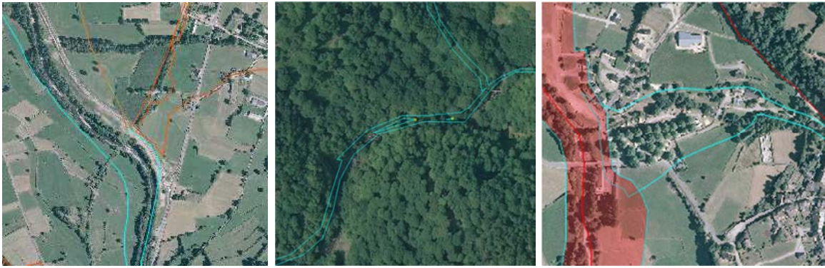
Figure 28 : Exemples d'erreurs relevées lors de l'expertise des couches vectorielles des phénomènes historiques. gauche : décalage dans la superposition de lignes communes doublées, centre : présence d'îlots de dimension incompatible avec l'échelle de restitution, droite : représentation erronée de l'interaction entre deux phénomènes.
